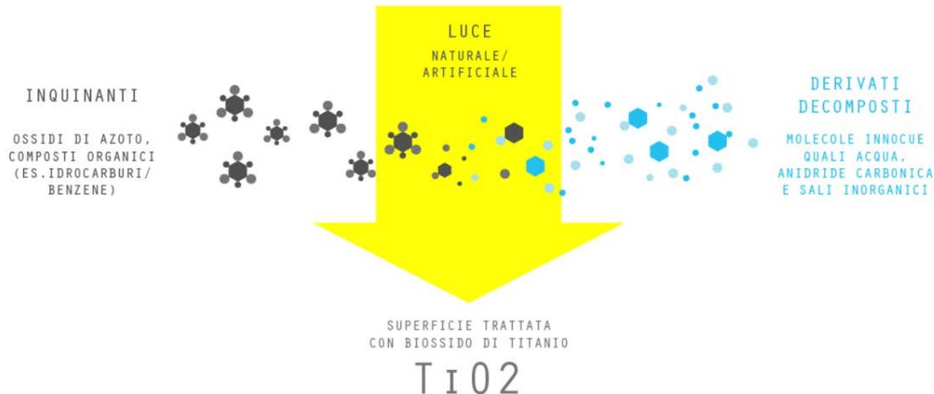
Le superfici così trattate sono in grado di eliminare automaticamente virus e batteri che vi si depositano solo tramite la loro esposizione alla luce solare o artificiale.
