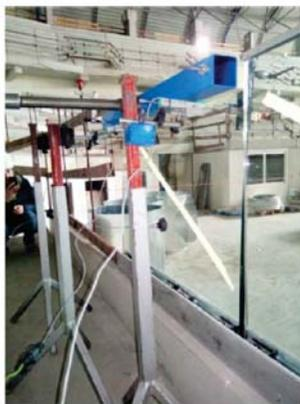
Particolare degli strumenti di misura dello spostamento
