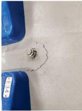
Rottura conica su solaio predalles sp.6 cm a 19 kN
