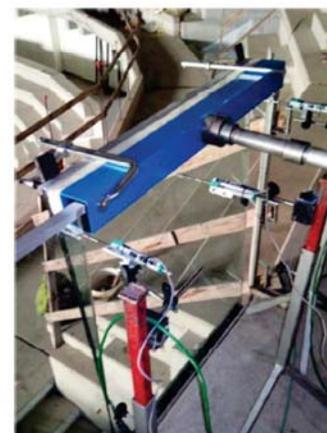
Particolare degli strumenti di misura dello spostamento
