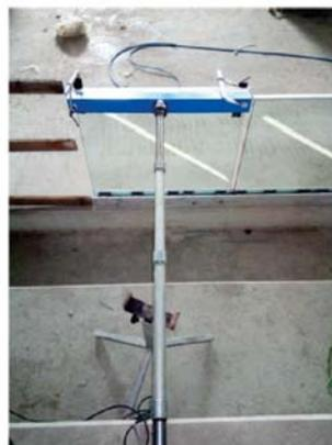
Fotografie della "Balastra tipo T5" sottoposta al carico di 900 kg/m
