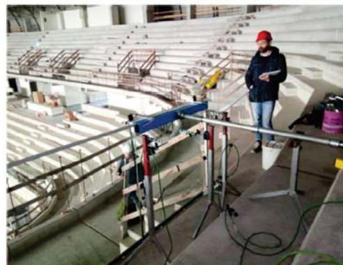
Fotografie della "Balastra tipo T1" durante la prova n. 3
