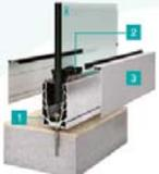
1. Profilo in alluminio estruso, forato alla base ogni 250 mm, predisposto per diverse tipologie di fissaggio: disponibile in base da 6 o 5 metri e a richiesta tagliato a misura.
