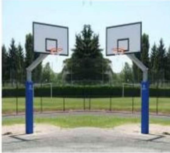
All'interno del campo da basket è stato installato un impianto pallacanestro "olimpionico" da fissare a terra. La struttura è monotubo in acciaio zincato a caldo per evitare arrampicamenti, sez. 15x15 cm con bussole da interrare e sbalzo da 220 cm. Completano l'impianto i tabelloni in resina melaminica, canestri e retine regolamentari.
