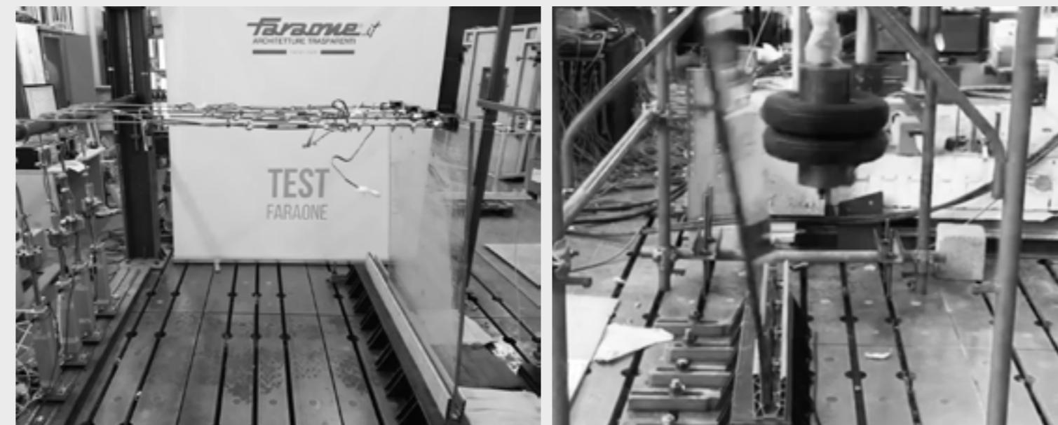
Le prove di spinta per la classe C2 sono pari a 200 kg/m testato a 300 kg/m
