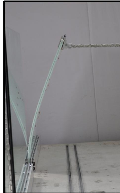
Vetri temprati stratificati con XLAB, rottura controllata di entrambe le lastre e prova di spinta sul pannello di vetro rotto.
