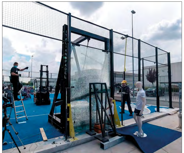
In alto, i campi padel del Timing di Brescia. In basso, test di rottura del vetro temperato (a sinistra) e del vetro stratificato (a destra). Nella pagina a lato, altre installazioni di Italian Padel.
