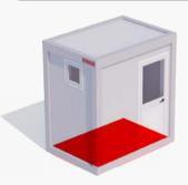
**PAVIMENTO**: Pannelli di legnocemento idrofugo spessore 22 mm con teli di PVC antiscivolo R10 spessore minimo 2 mm. Coibentazione sottostante composta da lastre in polistirene spessore 80 mm.
