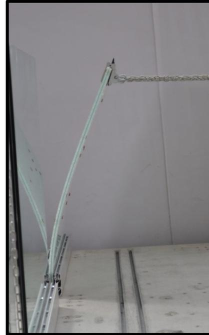
Vetri temprati stratificati con XLAB, rottura controllata di entrambe le lastre e prova di spinta sul pannello di vetro rotto.
