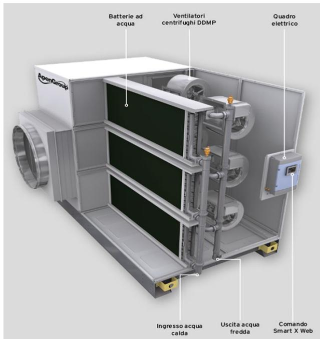
Le macchine sono modulari, costituite da moduli meccanicamente identici con batteria di scambio e sezione ventilante. Nel quadro elettrico di controllo è presente una scheda elettronica con funzione di comando master e a bordo di ciascun modulo è presente una scheda di collegamento e sicurezza.
