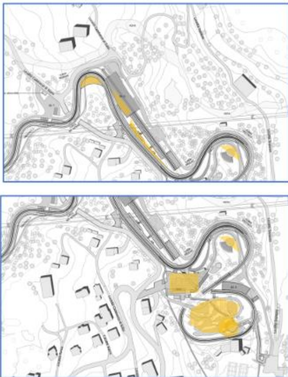
Figura 37- In giallo sono evidenziate le zone spettatori sistemate con livellamenti e fondo in ghiaio
